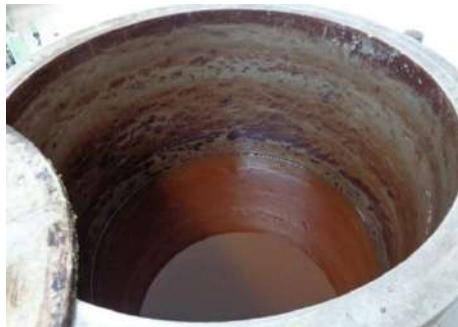
Figure 51 : Cuve de fonte contenant de la cire fondue
