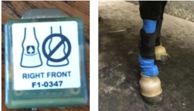
Figure 23 : Mise en place du capteur de l'antérieur droit (CHVE Livet)
