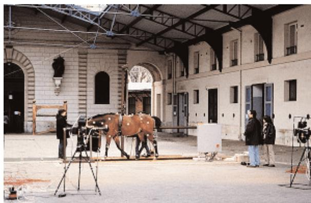
Figure 3 : B : Ensemble du dispositif d'enregistrement des données cinématiques et emplacement des caméras dans le cadre d'une analyse tridimensionnelle (Robert 2003)
