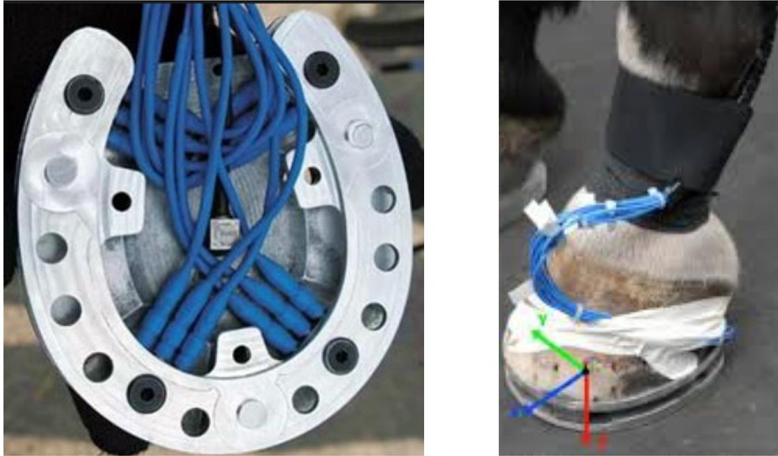
Figure 16 : Disposition des capteurs de force intégrés au fer instrumenté ; B : Disposition des fers instrumentés et des branchements de capteurs sur le pied du cheval. (Back and Clayton 2001)
