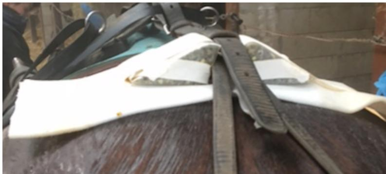
Figure 25 : Mise en place du capteur de croupe pour des évaluations attelées (CHVE Livet)
