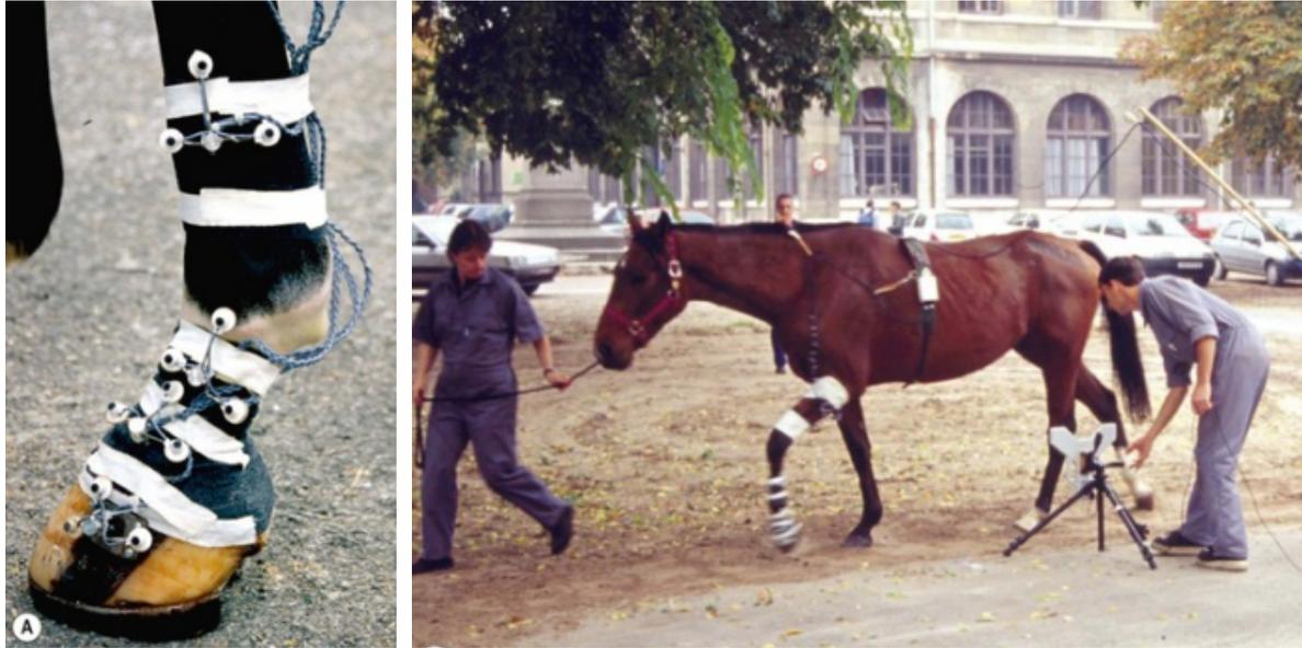
Figure 7 : A : Zebris CMS-HS : Modèle de fixation des microphones ultrasonores sur les parties distales du membre du cheval.
