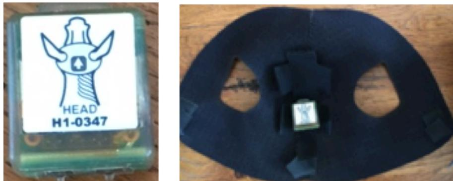
Figure 22 : Mise en place du capteur de tête (CHVE Livet)
