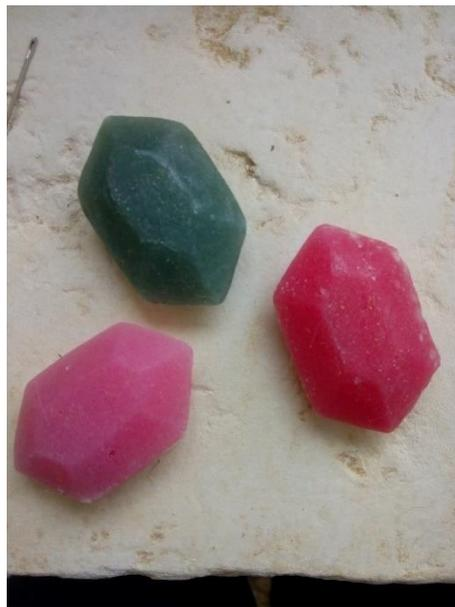
*Figure 21 : Tests des deux silicones, en vert et rouge le Dragon Skin Fx 10®, en rose l'Ecoflex 00-20®*
