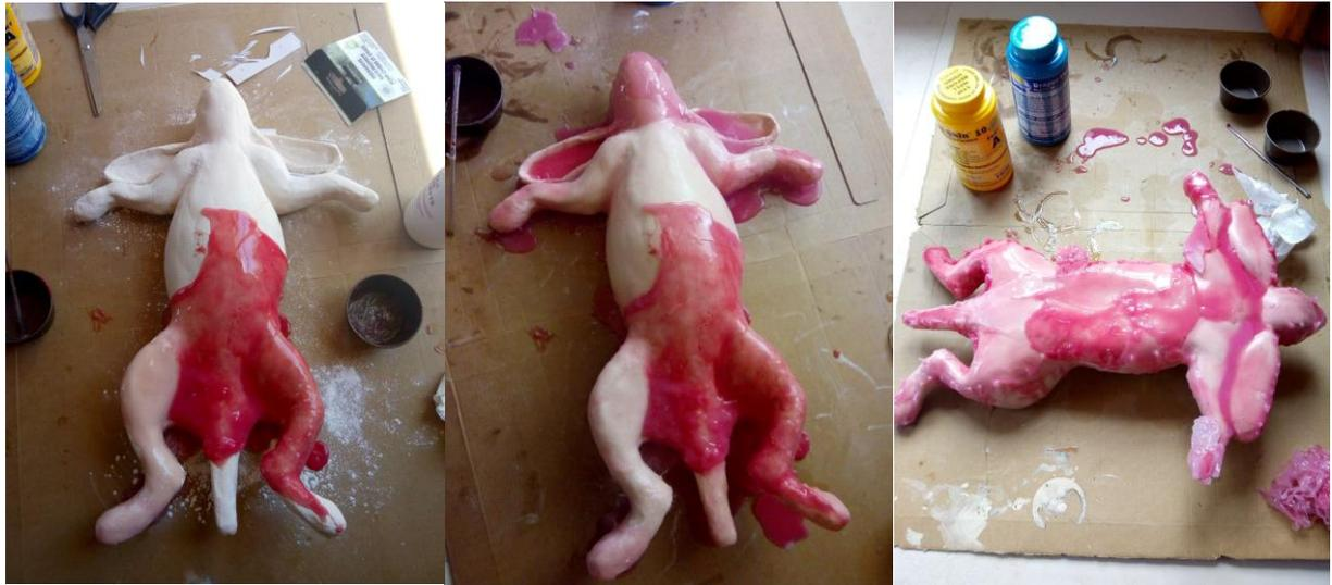
*Figure 24 : étapes de fabrication du moule en silicone*
