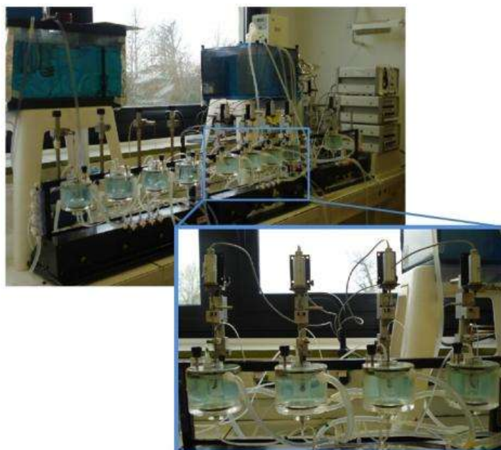
Figure 46 : Photographie du montage et agrandissement sur les cuves à organes isolés (encadré bleu)
